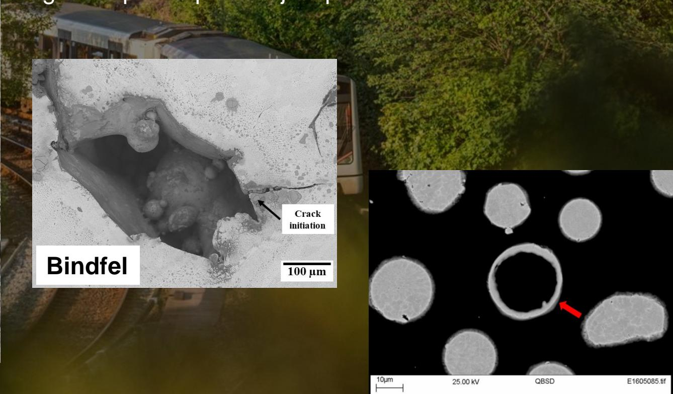
Pulverpartikkel med innesluttet argon gas fra pulver produksjonsprosessen
